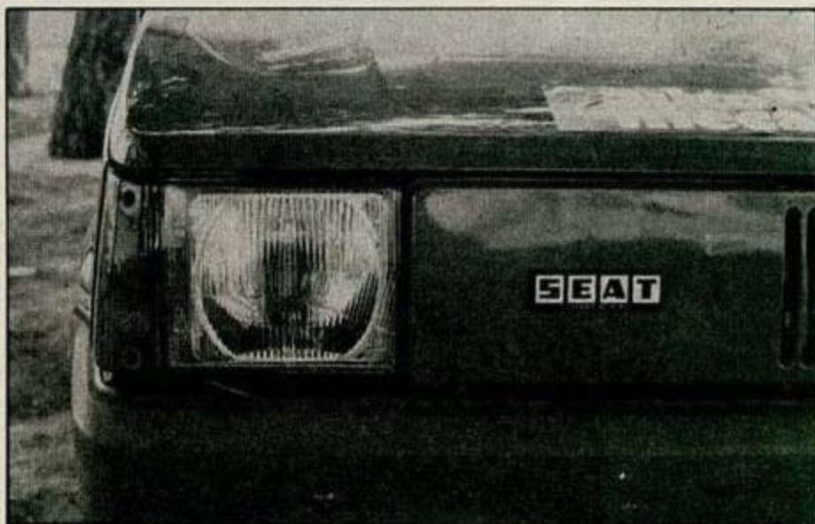
Los faros delanteros son de 45 vatios en luz de carretera y de 40 W en luz de cruce. Los intermitentes delanteros son de 21 vatios.
