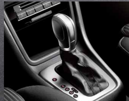
El cambio DSG combina la deportividad del cambio manual con las ventajas del automático.
