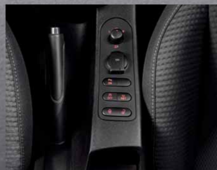
Desde la consola central se controla el bloqueo de puertas y la posición de los espejos retrovisores.
