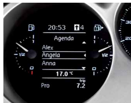
El cuadro de instrumentos dispone de un indicador de nivel específico para cada depósito.
