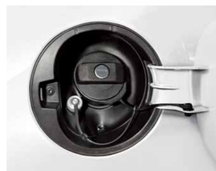
En los modelos con sistema BIFUEL las bocas de carga de GLP y gasolina están integradas detrás de la misma tapa lateral.
