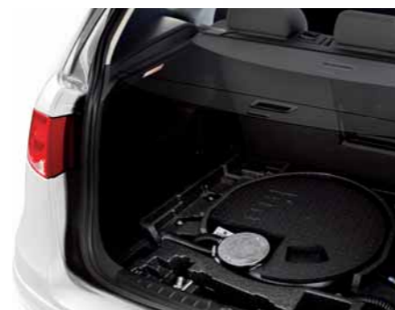
La ubicación del depósito GLP permite conservar capacidad de maletero.
